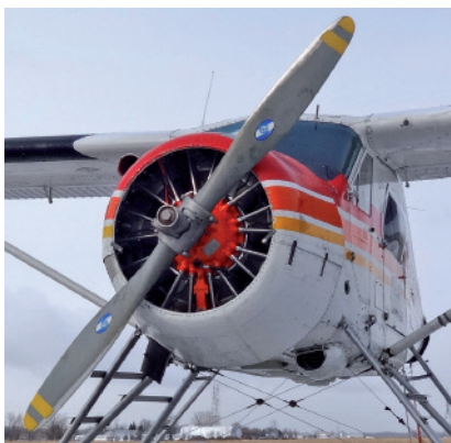
Bipale Hamilton Standard de type counterweight, montée sur C-GAZJ, Beaver n° de série 748 (Aviation La tuque).
