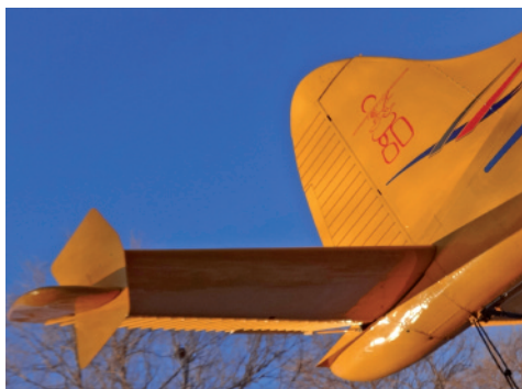
Empennage horizontal, muni de stabilisateurs de lacet, monté sur C-FLLX, Beaver n° de série 1293, présenté en ouverture d'article (aéronef privé).
