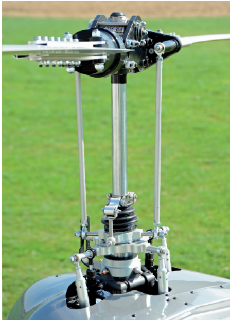
Rotor principal semi-rigide surmontant un mât éprouvé à + 22 g.
