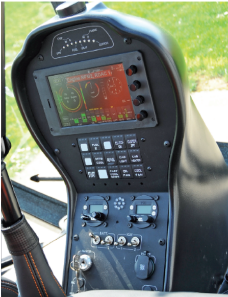
Console centrale intégrant un écran MGL Discovery 7 po (18 cm).
