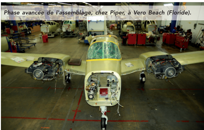
Lycoming LO-360-A1H6, en cours de montage sur une cellule de Seminole.
