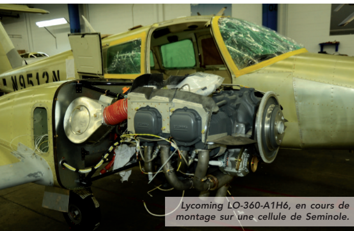
Phase avancée de l'assemblage, chez Piper, à Vero Beach (Floride).
